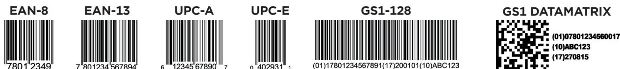
**Identificadores de Aplicación:** prefijo numérico que se utiliza en el sistema GS1 para concatenar datos en las simbologías estándar avanzadas (GS1-128; GS1 DataMatrix y GS1 QR). Especifican el tipo de dato, así como su formato. Por ejemplo, el Identificador (10) se refiere a que el dato que viene a continuación corresponde al lote, y este dato puede ser numérico o alfanumérico de hasta 20 caracteres.
